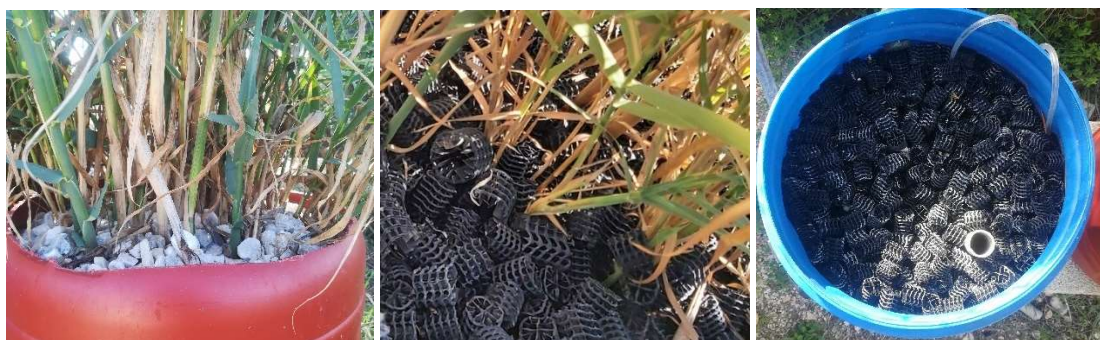
Εικόνα 3.6 Απεικόνιση των επιφανειών των υποστρωμάτων των μονάδων G (αριστερά), P (μέση) και C (δεξιά).
