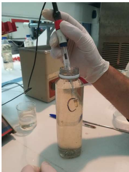
Εικόνα 3.8 Υπολογισμός pH εκροής, με βύθιση του ηλεκτρόδιου
